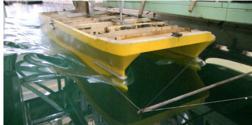
(b) 风电运维船缩尺船模水池试验场景
