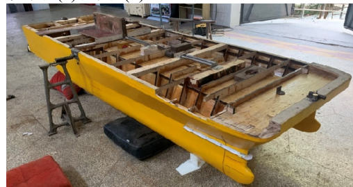
(a) 缩尺比为9:1的风电运维船试验船模
