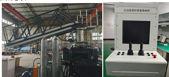
(a) 栈桥主体结构 (b) 操控控制台
